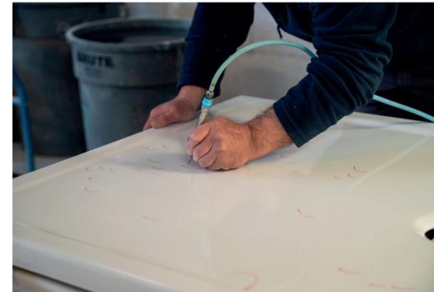
**9** Contrôle, tri, réparation à froid ou à chaud (recuisson)
