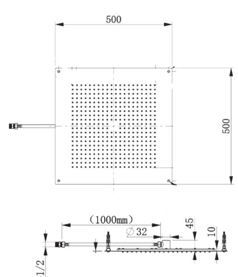
Recommandation d'encastrement : 9 cm entre plafond et faux-plafond
